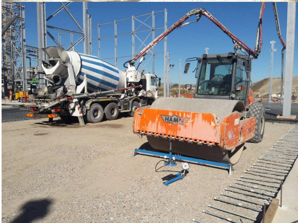
ESECUZIONE DI PROVE DI CARICO SU PIASTRA STANDARD NORMA SVIZZERA E NORMA CNR.
