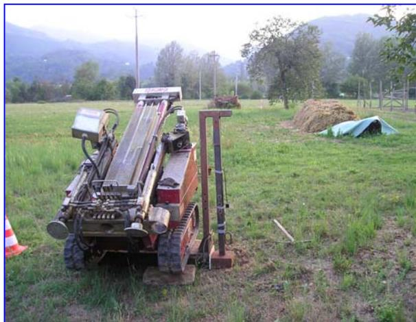
*Energizzazione in onde P con maglio da 200 kg in caduta libera e energizzazione in onde Sh con pendolo da 30 kg*
